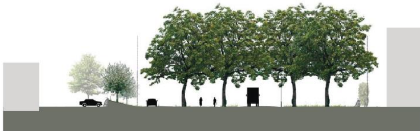
Referentie huidig profiel Hoofdlaan 7Poort I van 47 meter breed. Voor 7Poort II te verbreden tot 120 meter tussen woonwijk en uitgifbare kavels.
